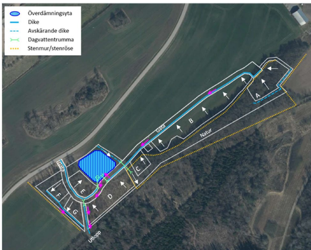
Bild visar föreslagna övergripande dagvattenåtgärder. Primära rinnvägar är markerade med vita pilar och sekundära rinnvägar med rosa pilar.
