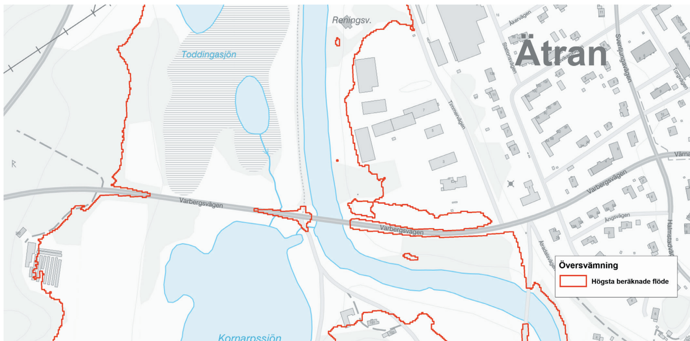
Figur 19 Översvämning av väg 153 vid Ätran vid ett högsta beräknat flöde.
