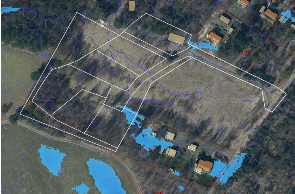
Figur 22. Lokala lågpunkter och rinnvägar vid skyfall för befintligt område och nederbörds mängd 46 mm. Ungefärlig planområdesgräns markerad med vit färg.
