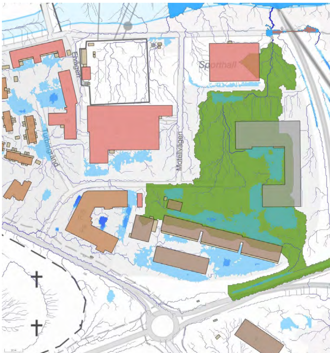
Figur 31 Ytliga rinnvägar och områden som riskerar översvämning utifrån befintlig situation vid 50 mm intensivt regn.
