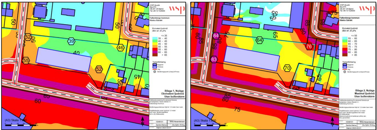
Figur 17. Bullerutbredningskartor nuläge. Kartan till vänster visar ekvivalent ljudnivå i dagsläget. Kartan till höger visar maximal ljudnivå i dagsläget.
