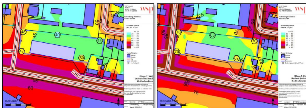
Figur 28. Bullerutbredningskartor utbyggnadsalternativ 2045 med bullerskärmar. Kartan till vänster visar ekvivalent ljudnivå år 2045 med bullerskärmar. Kartan till höger visar maximal ljudnivå år 2045 med bullerskärmar.
