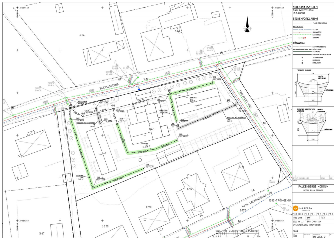
Bilaga 2, Dagvattenutredning, Markera 2022-06-22. Redovisar en möjlig öppen dagvattenhantering med gräsbeklädda svackdiken (gröna) samt krossdiken med vegetation (gråa) för optimal fördröjning och rening av dagvattnet utifrån ställda krav.
