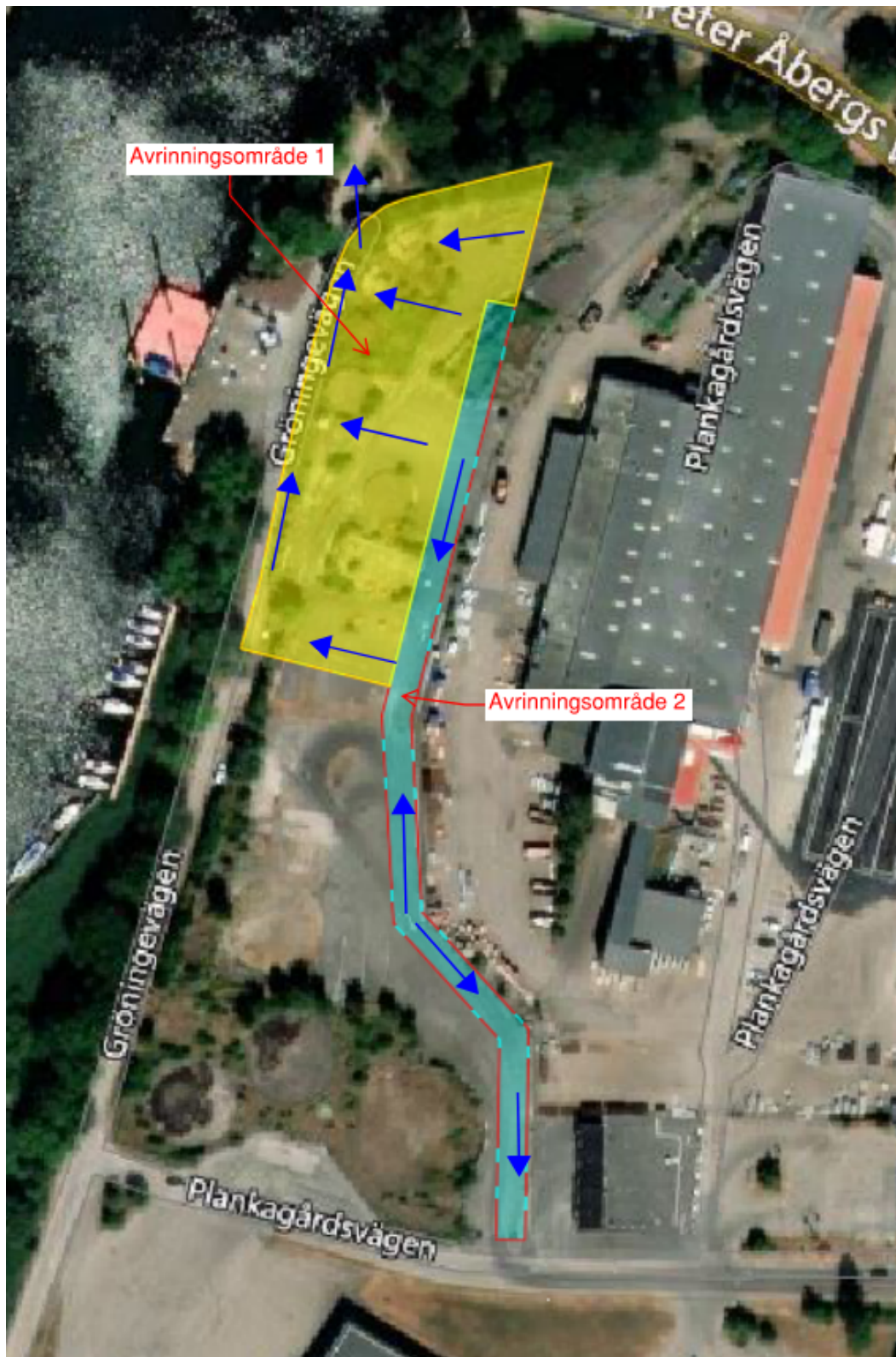
Figur 2-8. Avvattningsplan och indelning av avrinningsområde för planerad situation.
