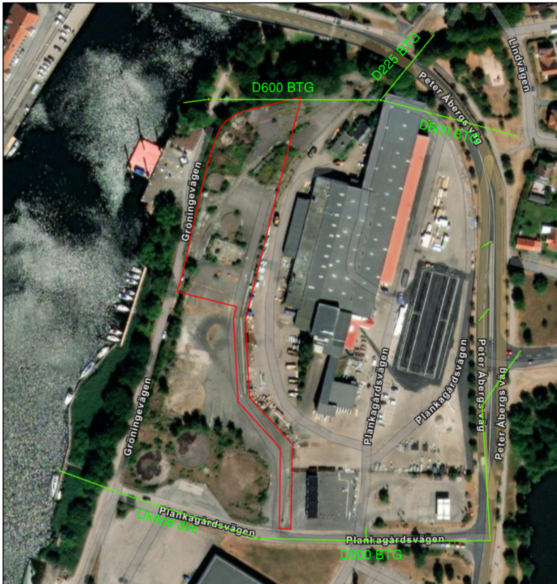
Figur 2-7. Befintligt dagvattensystem i anslutning till planområdet.
