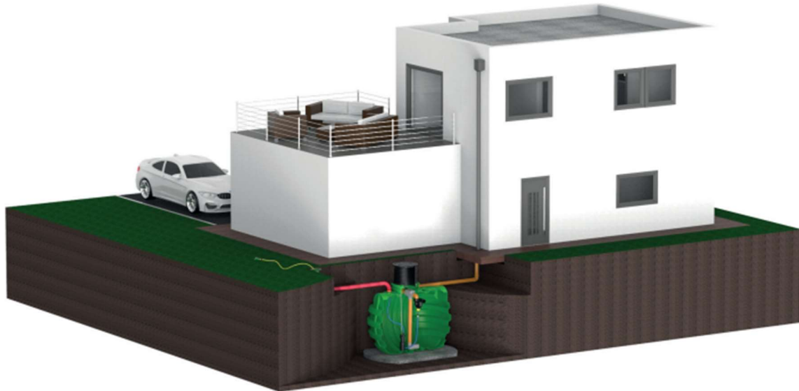
Figur 15. Exempel på system med återvinning av regnvatten. (AB Evergreen Solutions, 2022)
