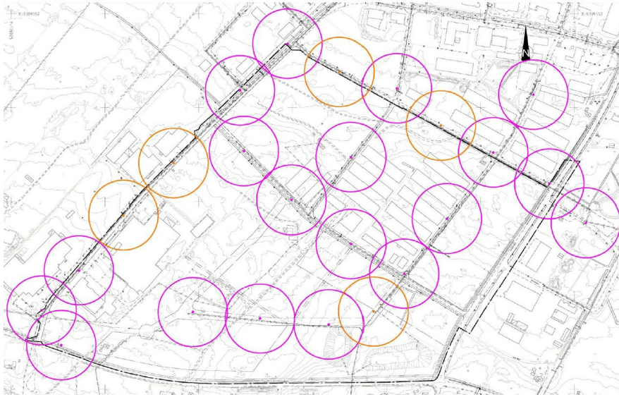
Bild på existerande (rosa) och föreslagna (orange) brandposter, schematisk placering. Bild av Markera.
