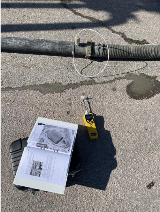
Figur 1. Mätning med PID på luften från hammarborrning
