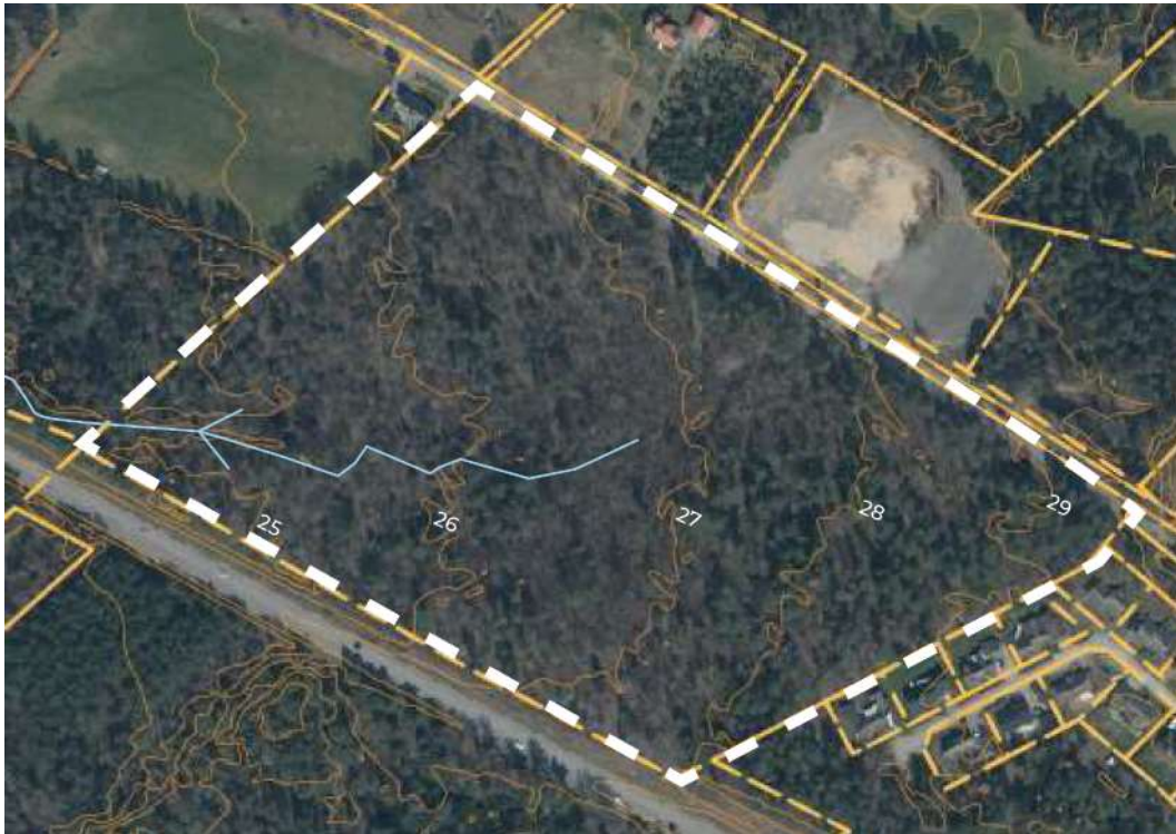
Figur 5: Planområdet är markerat med vit streckad linje, Kvicksandsbäcken är illustrerad med blå linje, siffror anger marknivåer i meter över nollplanet och gula streckade linjer är fastighetsgränser.
