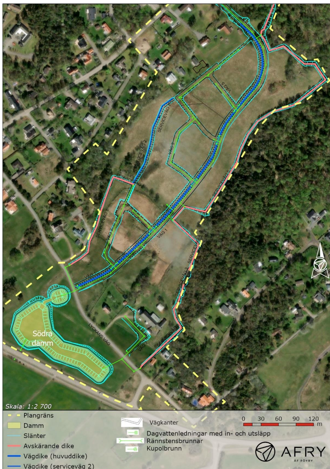
Figur 13. Schematisk skiss på dagvattenlösningar och dräneringslösningar inom detaljplaneområdets södra del.
