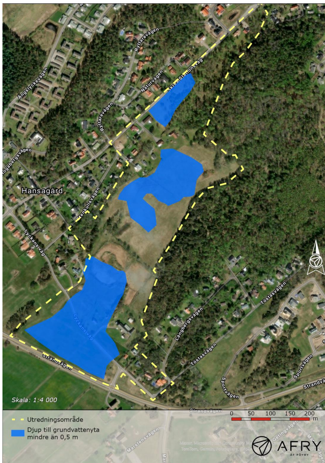
Figur 9. Djup till grundvattenyta mindre än 0,5 m. Figuren är skapad genom att en interpolerad grundvattenyta från manuella mätningar genomförda 2024-01-24 har dragits bort från Lantmäteriets höjddata 1x1m.
