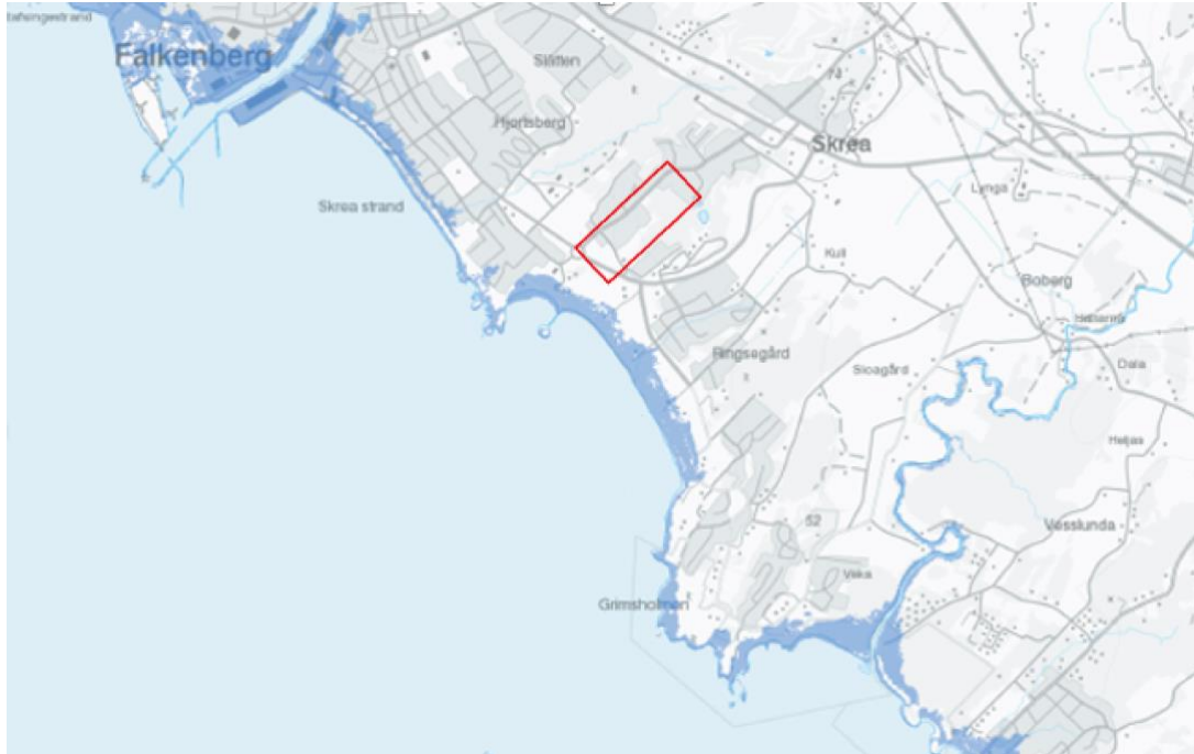
Figur 21. Mörkblå yta visar hur en havsnivåhöjning på cirka en meter kombinerat med en storm från västlig sektor kan se ut för den södra kuststräckan i Falkenberg i förhållandet till planområdet, vars placering illustreras med röd fyrkant. Justerad figur från Falkenberg kommun, 2021.
