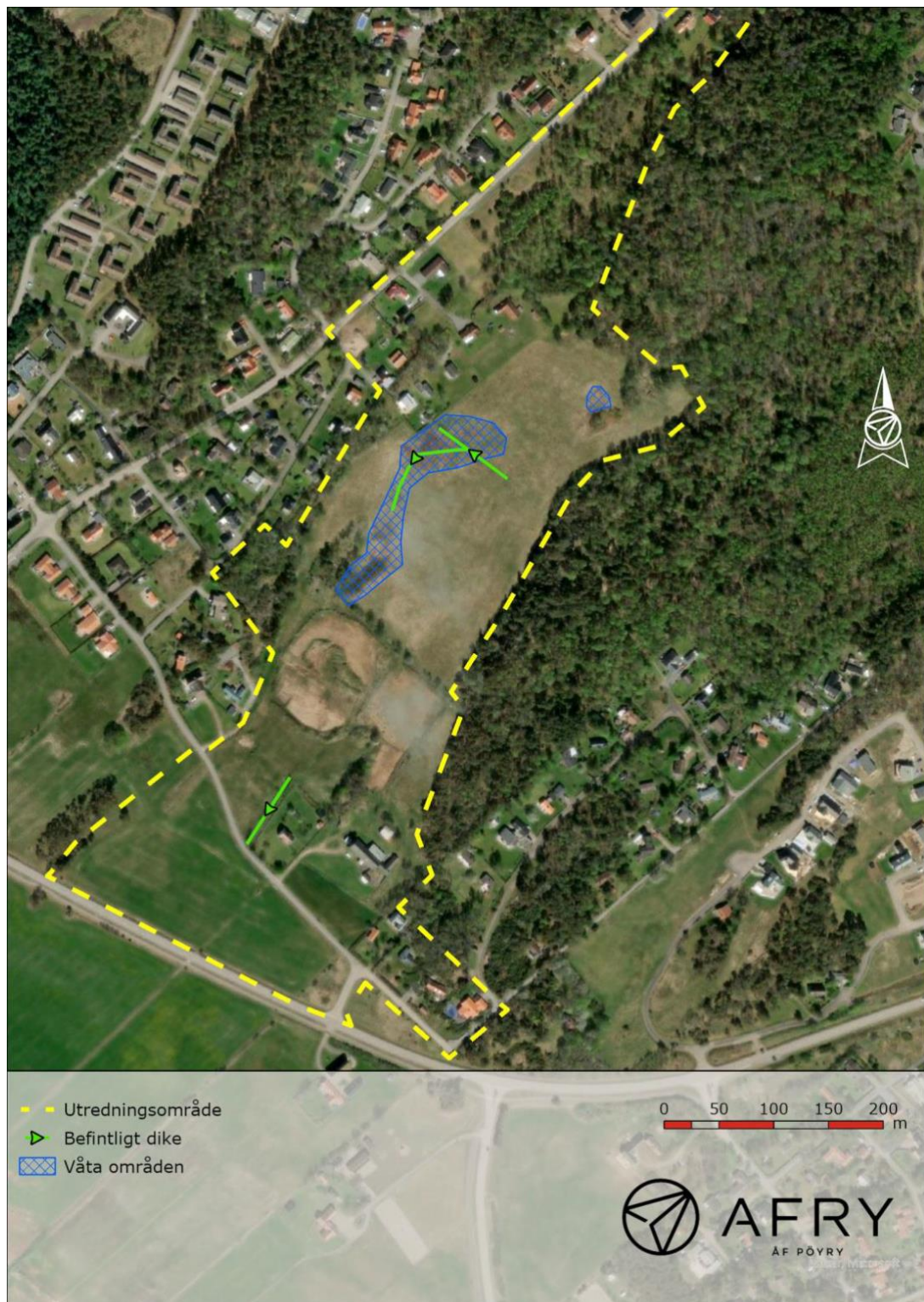
Figur 10. Identifierade våta områden, märgelhåla/källa i nordost (återfanns ej vid platsbesök 2022-12-09) och utdikad sänka i nordväst samt dike i söder (Afrý, 2025b). Strömningsriktning i diken är antaganden och ej bekräftade i fält.
