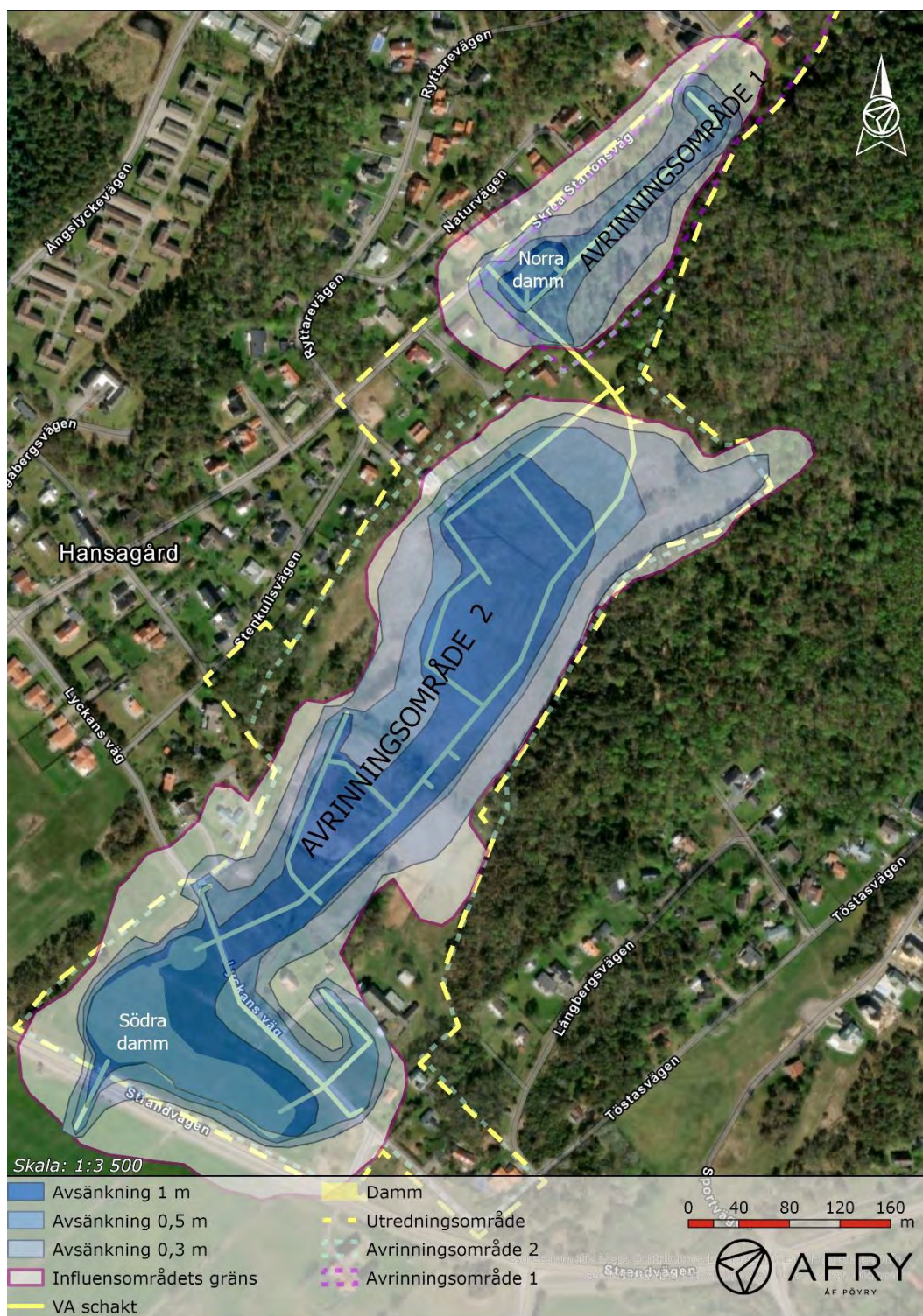
Figur 7. Influensområdet utbredning i byggskede med markerade avsänkningsnivå på 1,0, 0,5 och 0,3 m.
