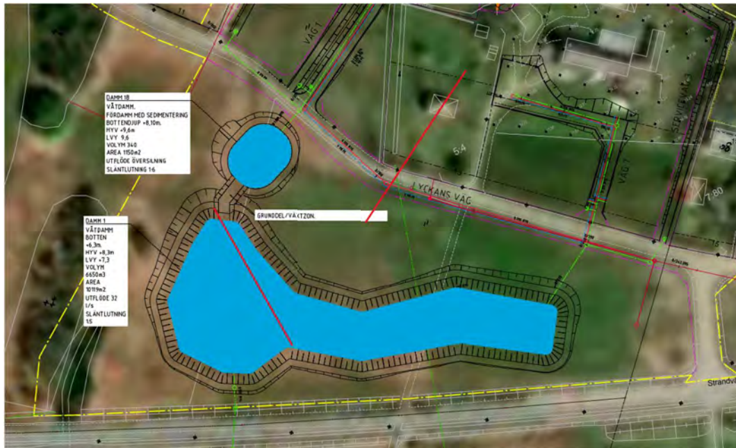
Figur 8 Projekterad damm för avrinningsområde 1.
