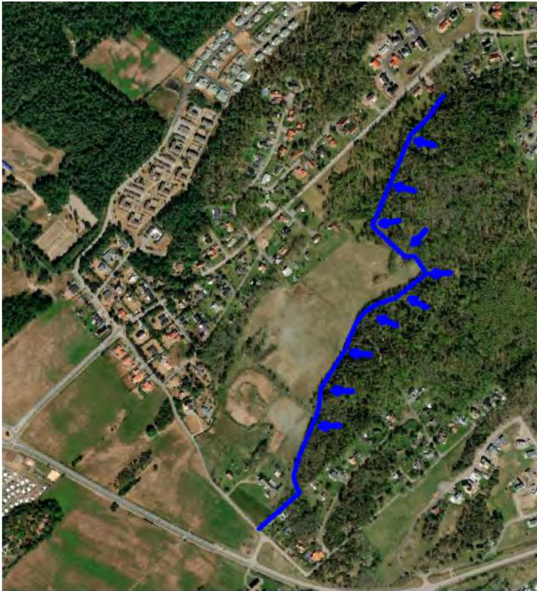
Figur 4 illustrativ bild på avskärande dike.
