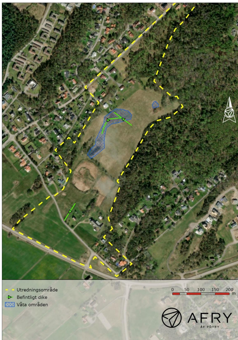
Figur 13. Identifierade blötområden vid fältbesök 2022-12-09; mägerhåla i norr och utdikad sänka i nordväst (AFRY, 2022-12-09); samt dike i söder (tillkommande information från kommunen 2023-08-24).
