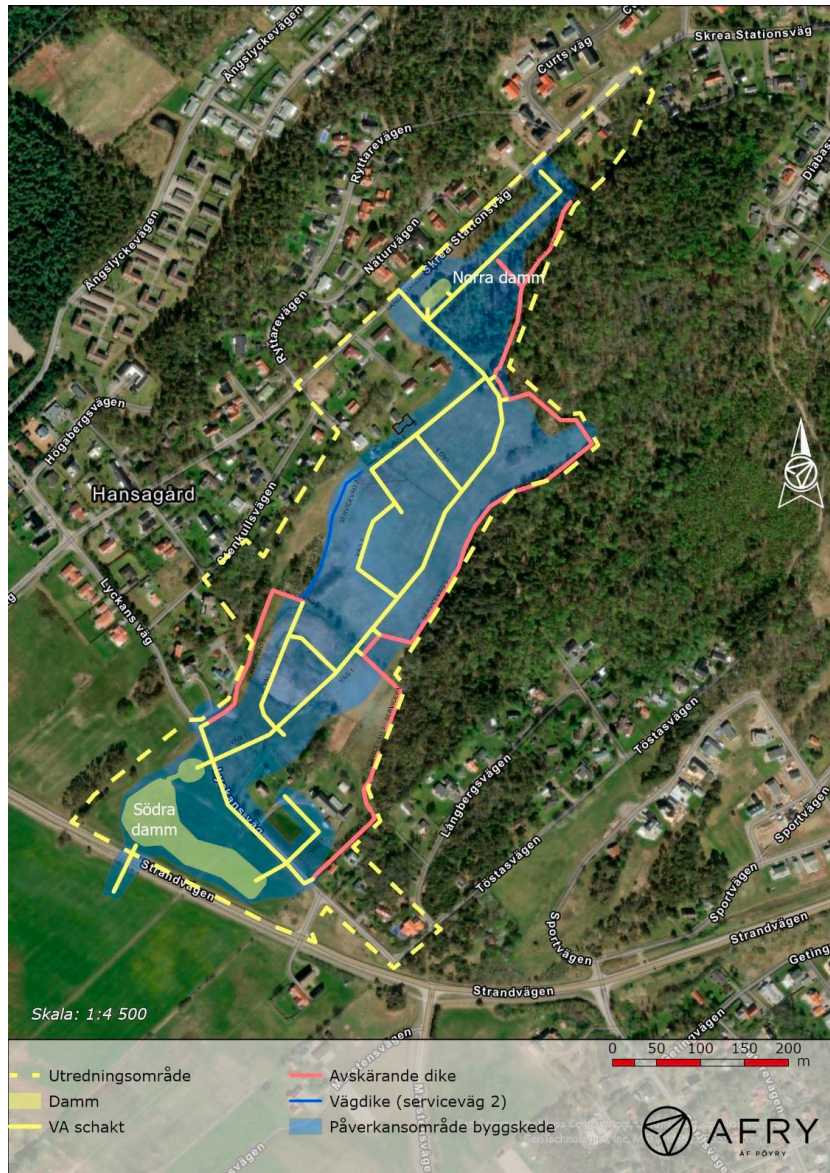
Figur 15. Påverkansområde under byggskede, sammanställd påverkan av vattenbortledning från damm- och VA-schakter och dike (Afrý, 2025b).
