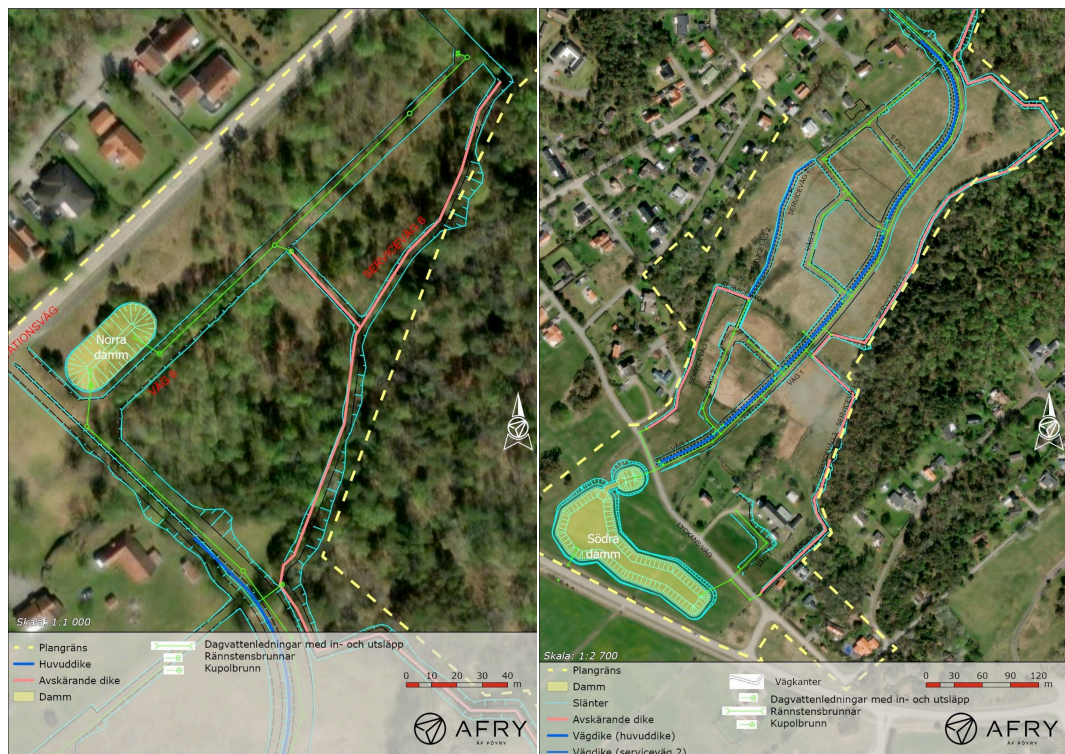
Figur 14. Schematisk ritning med dagvattenlösningar och dräneringslösningar inom detaljplanområdet. Vänster figur visar Avrinningsområde 1, som utgör den nordligaste delen av detaljplanområdet, och höger figur visar Avrinningsområde 2 i de centrala och södra delarna av detaljplanområdet (Afrý, 2025b).
