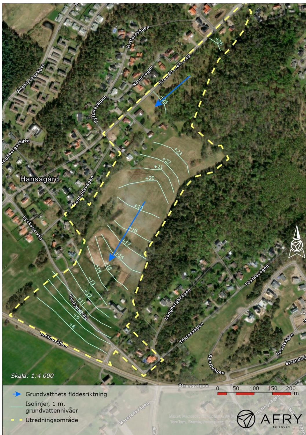
Figur 17. Interpolerade grundvattennivåer från mätfallet 2024-03-25.
