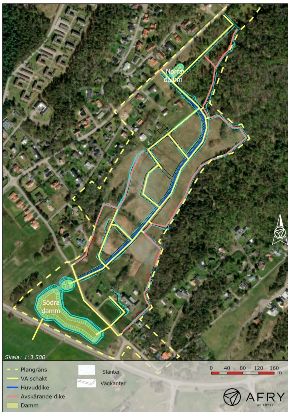
Figur 25. Grundvattenpåverkade anläggningar under byggskede: VA schakter, dammar och dike.
