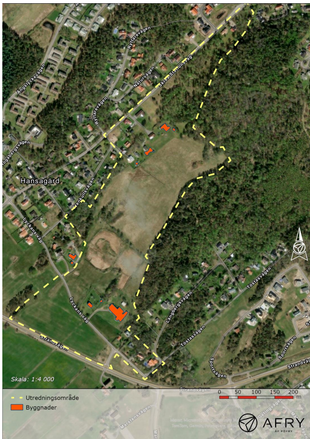
Figur 23. Identifierade byggnader potentiellt utsatta för skador till följd av grundvattenavsänkning.
