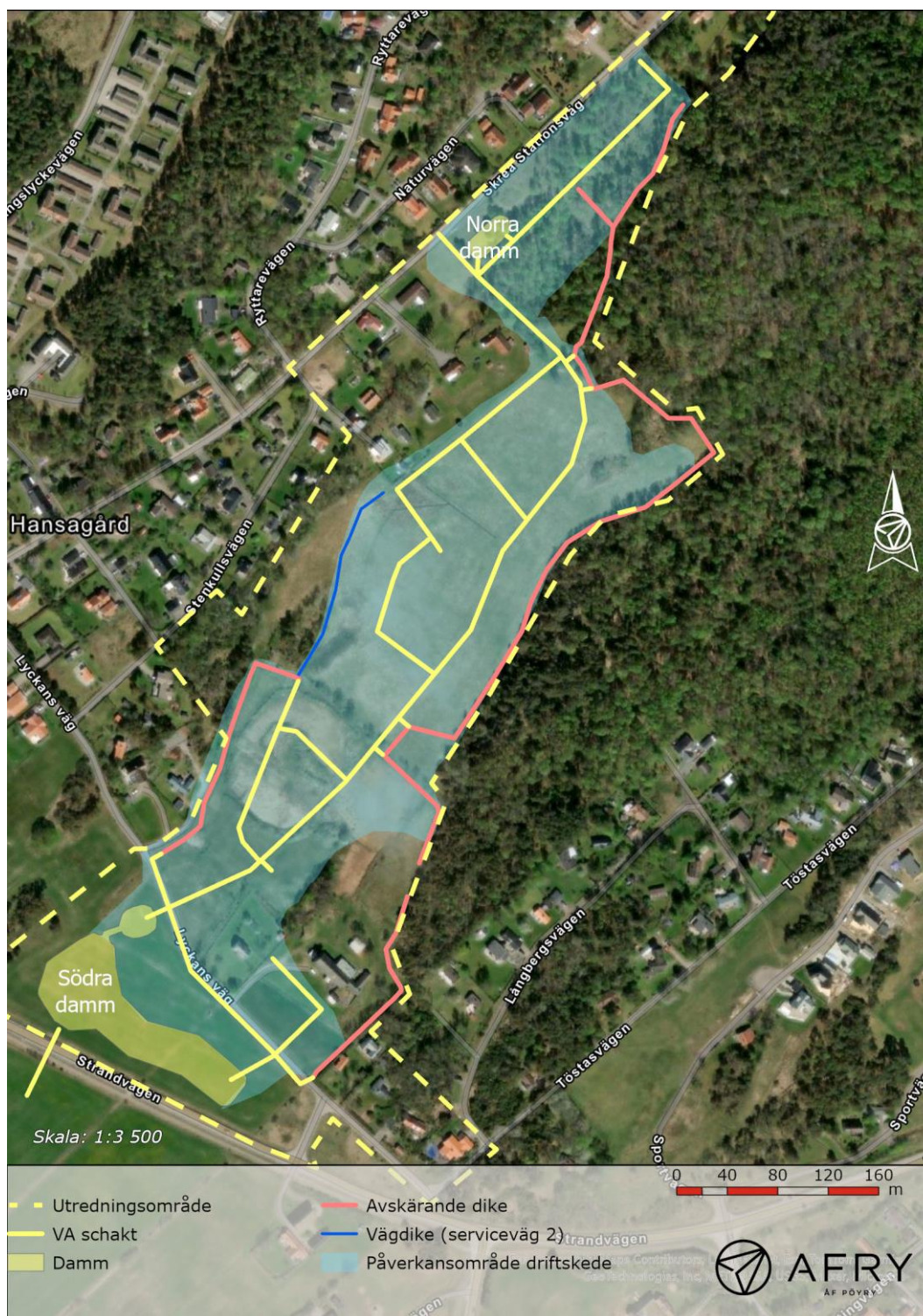
Figur 29. Påverkansområde driftskede. Sammanlagd påverkan vid förutsättning att grundvatten sänkts 1 m inom området.
