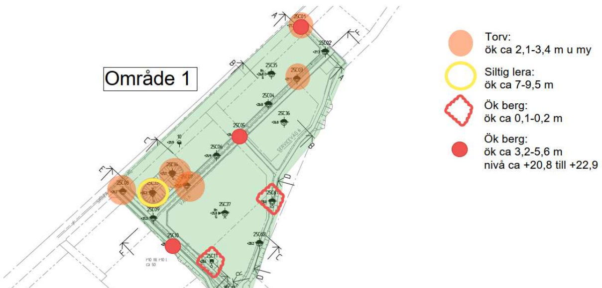
Figur 3: Område 1: förekomst av torvskikt i sandlager, lerjord samt ringa djup till berg.
