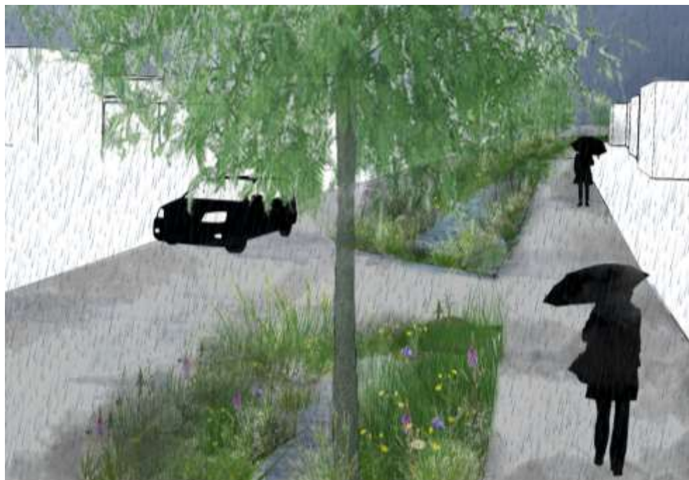
Figur 19 Öppen dagvattenhantering i gata genom regnbäddar
