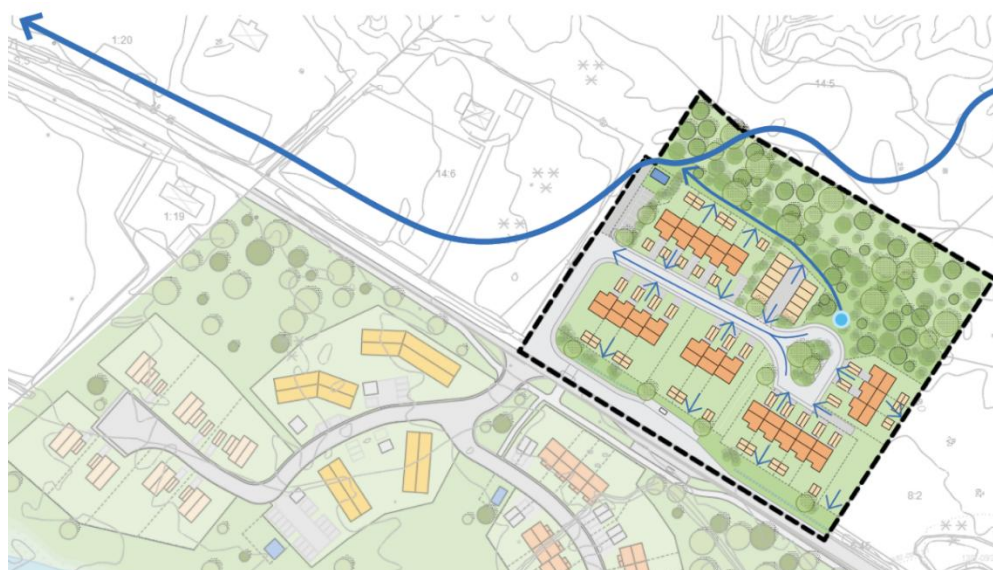
Figur 15. Den tjocka blå pilen illustrerar befintligt lågstråk från golfbanans område, som rinner vidare till befintlig lågpunkt nordväst om planområdet. Blå pil norr om bostäderna illustrerar ytledes rinnstråk för vatten som bräddar när Kvicksandsbäckens ledning går full. Tunna blå pilar illustrerar principer för höjdsättning. Illustration erhållen av Falkenbergs kommun, 2026.
