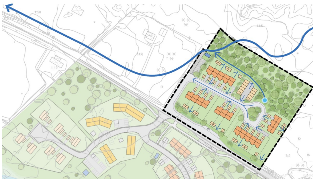
Figur 17: Den tjocka blå pilen illustrerar befintligt skyfallsstråk från golfbanans område, som rinner vidare till befintlig lågpunkt nordväst om planområdet. Blå pil norr om bostäderna illustrerar ytledes rinnstråk för vatten som bräddar när Kvicksandsbäckens ledning går full. Tunna blå pilar illustrerar principer för höjdsättning så att marken lutar bort från byggnaderna och kvartersgatan som rinnväg åt nordväst.
