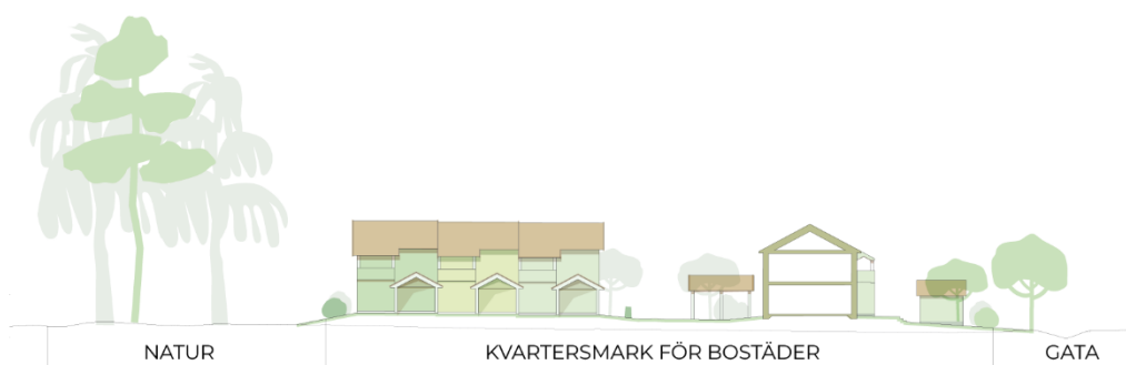
Figur 10: Sektion B-B. Befintlig respektive ny marknivå redovisas med tunn respektive tjock linje.
