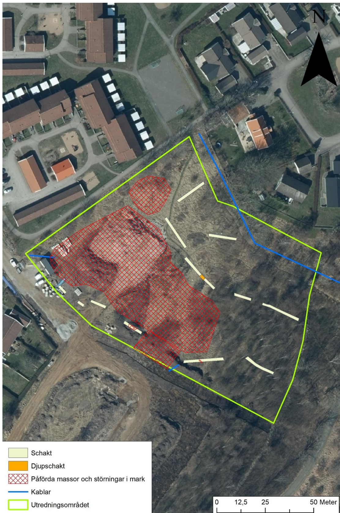
Figur 1. UO med schakt och störningar. Skala 1:1000.
