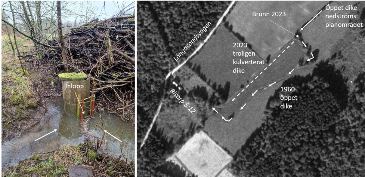
Figur 11. Höger bild visar en brunn i det nedströmsdike som avvattnar det södra avrinningsområdet inom planområdet. (Platsbesök, 2023) Vänster bild är ett ortofoto som visar dikets sträckning 1960 med skissad trolig kulvertering 2023.
