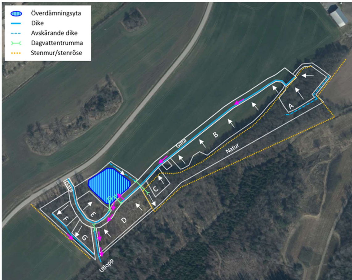
Figur 19. Föreslagna övergripande dagvattenåtgärder. Primära rinnvägar är markerade med vita pilar och sekundära rinnvägar med rosa pilar.
