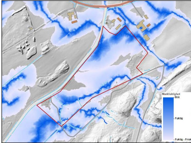
Figur 8. Kartan visar markfuktighet beräknat som avståndet ner till en modellerad grundvattenyta (Skogsstyrelsen, 2023)
