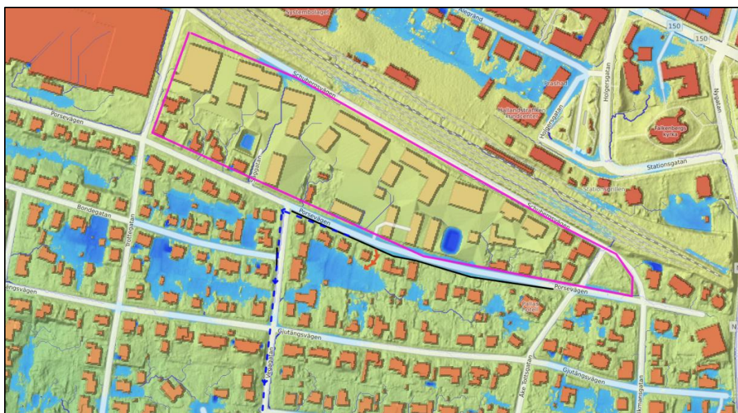
Figur 17. Planerad situation klimatanpassat 100 års regn. Utredningsområdet illustreras som lila linje. Föreslagen sekundär avrinning kan uppnås enligt blå streckad linje vid en höjdjustering av Porsevägen / avgränsande kantstöd (svart linje) mot fastigheter på +6.50. Befintlig sekundär avrinning via orange pil.
