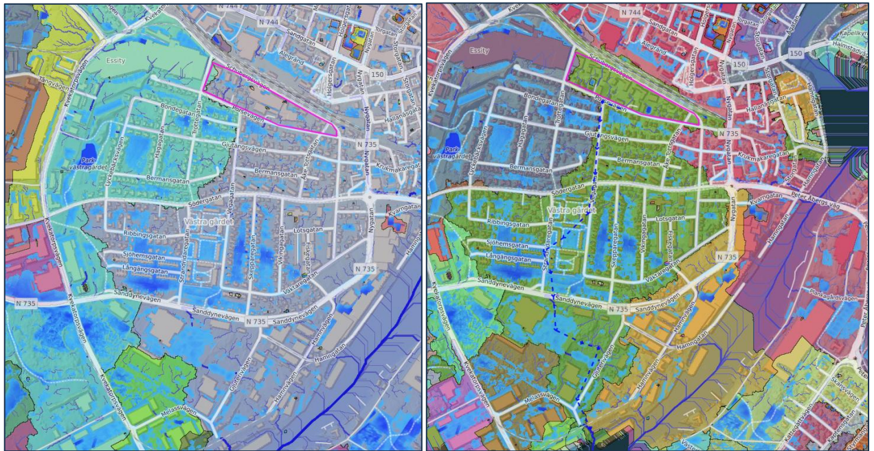
Figur 18. Befintlig situation till vänster och planerad situation till höger klimatanpassat 100 års regns avrinningsområden. Utredningsområdet illustreras som lila linje. Se framtida avrinningsväg som blå streckad pil.
