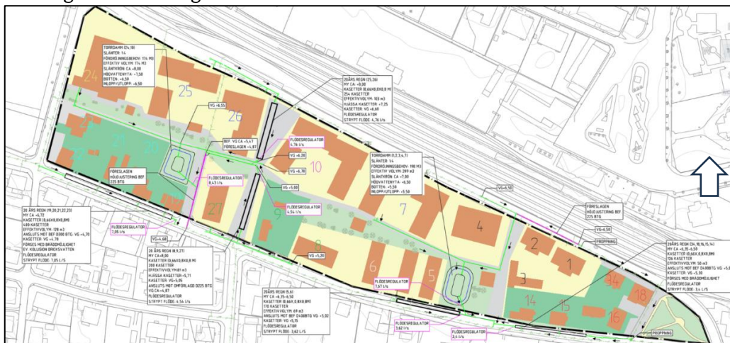
Figur 13. Dagvattenprincip i förhållande till den befintliga och planerade bebyggelsen. Dagvatten fångas upp via rännstensbrunnar, kupolsilsbrunnar och stuprör för att sedan transporteras mot föreslagna fördrojningsåtgärder. Bruna ytor illustrerar takytor, gråa asfalterade/hårdgjorda ytor, gröna ytor (vegetationsytor) (mörkgröna ytor befintliga grönytor) och gula ytor kvartersmark. Utredningsområdet illustreras som
