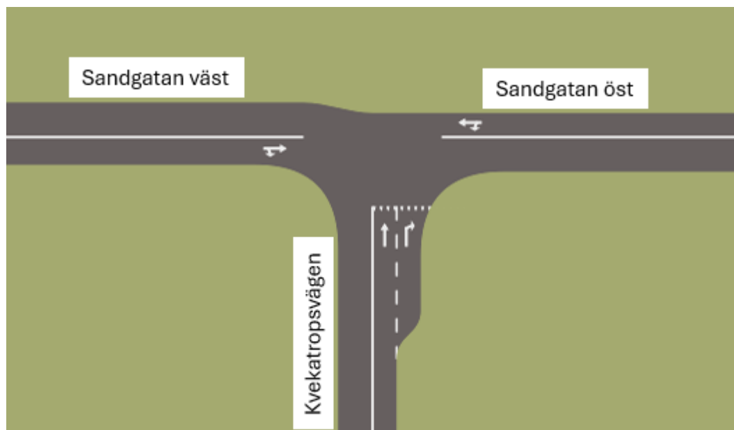
Figur 13. Utformning för korsningen Sandgatan / Kvekatorpsvägen med två körfält på Kvekatorpsvägen.
