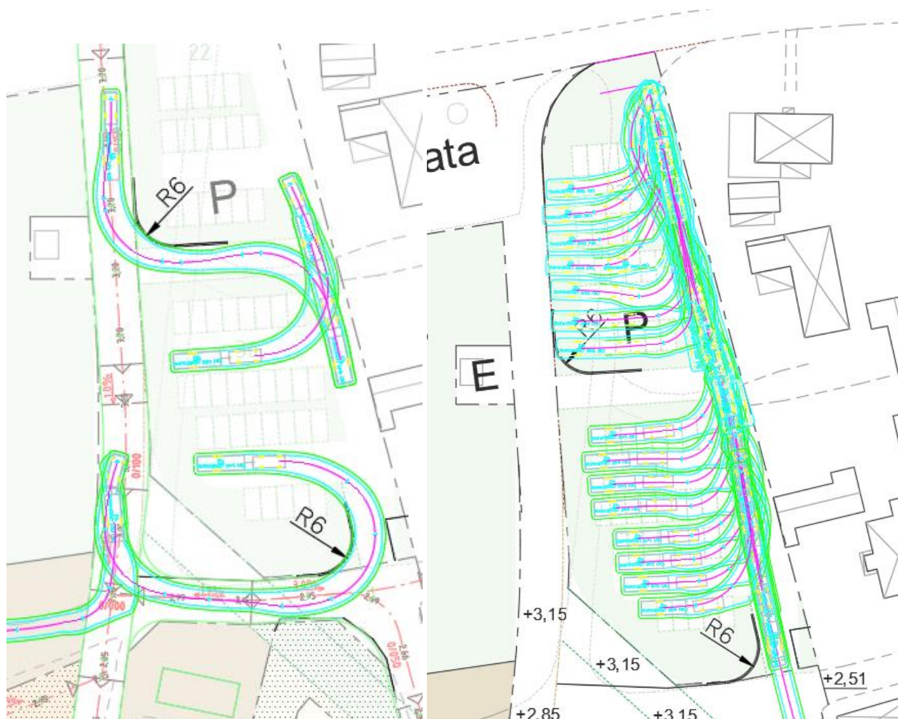
Figur 21: Vänster bild visar kurvradiet som bör användas vid dimensionering av utfarterna för att tillåta enkel utfart från uppställningsområdet. Höger bild visar uppställningsplatser med personbil + båtsläp på parkeringsytan (ett säkerhetsavstånd på 5 meter har tagits från Glumstenvägen på grund av lutningen från denna ned mot parkeringsytan).
