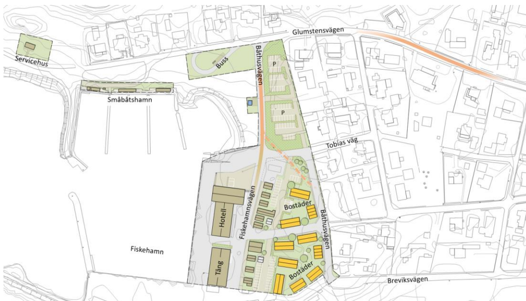
Figur 6: Förslag till bebyggelse. Orange heldragen linje markerar ungefärlig sträcka av Glumstenvägen respektive Båthusvägen som behöver höjas till nivå +3,15. Med hänsyn till befintlig bebyggelse kan Båthusvägen inte höjas i korsningen med Tobias väg. Istället planeras en räddningsväg på nivå +3,15, som är markerad med orange streckad linje. Söder om räddningsvägen faller Båthusvägen av och möter Fiskehamnsvägen på nivå +2,85 framför hotellets entréyta.
