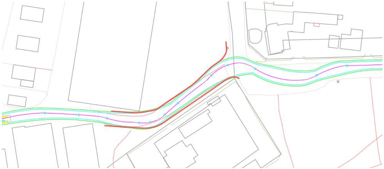
Figur 18. Körspår i västlig riktning i korsningen Båthusvägen och Breviksvägen, med expanderad vägbana samt kurvradie. Röd linje indikerar förslag på expanderad vägbana.
