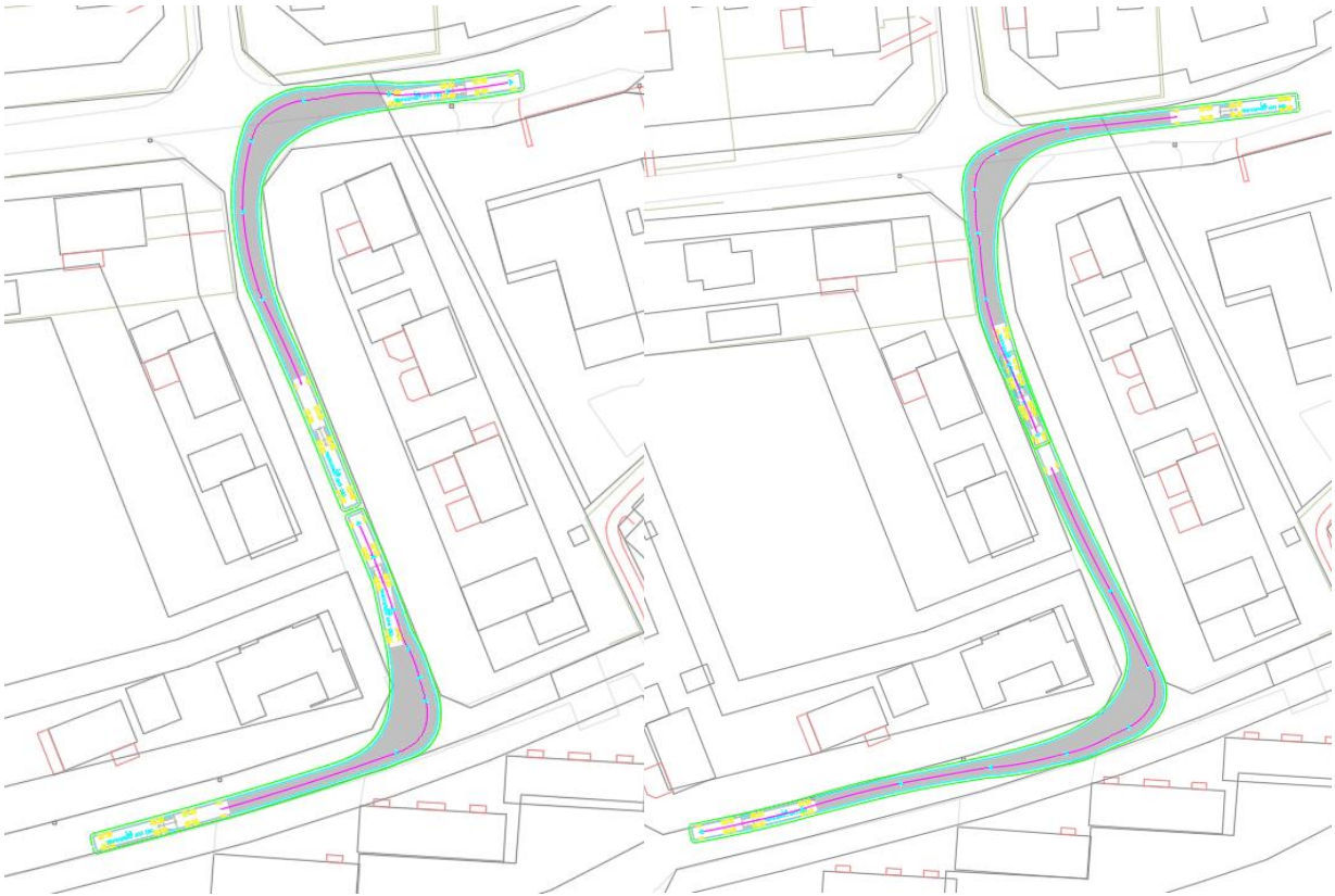
Figur 14. Körspår korsning Breviksvägen och Fyrkarlens väg. Bild till vänster visar östlig riktning. Bild till höger visar västlig riktning.
