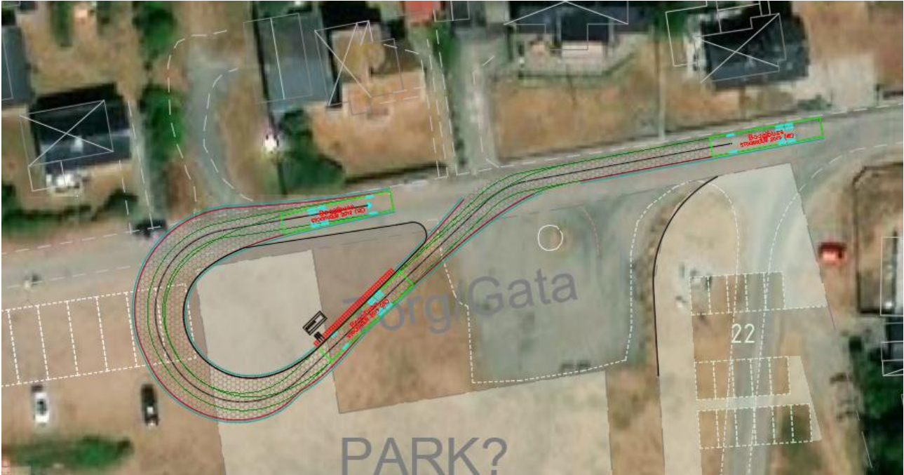
Figur 8: Föreslagen skiss på hållplatsläge och vändmöjlighet för boggibus. Bild: WSP
