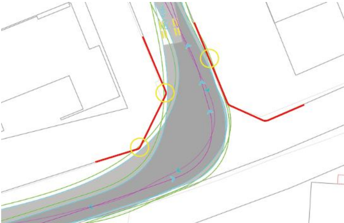
Figur 15. Körspår korsning Breviksvägen och Fyrkarlens väg, för båda riktningarna. De mörka fälten indikerar svepytan för fordonet, den gröna linjen är en säkerhetszon på 0,5 meter på vardera sida av fordonet, för att ta höjd för sidospeglar och andra eventuella objekt som kan sticka ut på fordonet. De röda linjerna visar fastighetsgräns med staket, och de gula ringarna visar de områden som är i riskzon.
