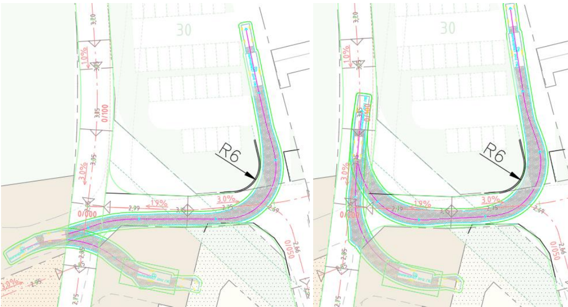
Figur 20: Två liknande körspår från spolplattan till uppställningsområdet som börjar med en backningssekvens
