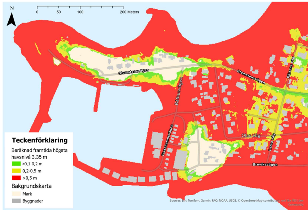
Figur 2-4. Utbredningen av vatten samt vattendjup vid beräknad framtida högsta havsnivå på 3,35 m. Grönt = vattendjup på 10–20 cm, gult = vattendjup på 20–50 cm, rött = vattendjup mer än 50 cm
