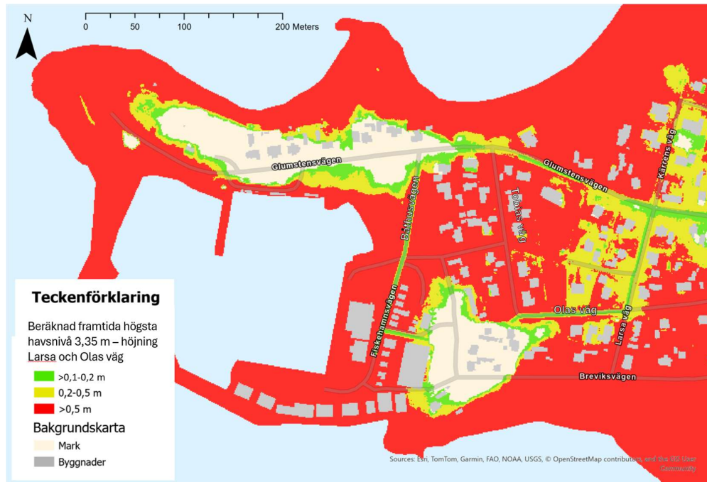
Figur 2. Utbredningen av vatten samt vattendjup vid en beräknad högsta havsnivå på 3,35 m och om Båthusvägen, Fiskehamnsvägen, Larsa väg och Olas väg höjs till nivå 3,15 m. Grönt = vattendjup på 10–20 cm, gult = vattendjup på 20–50 cm, rött = vattendjup mer än 50 cm
