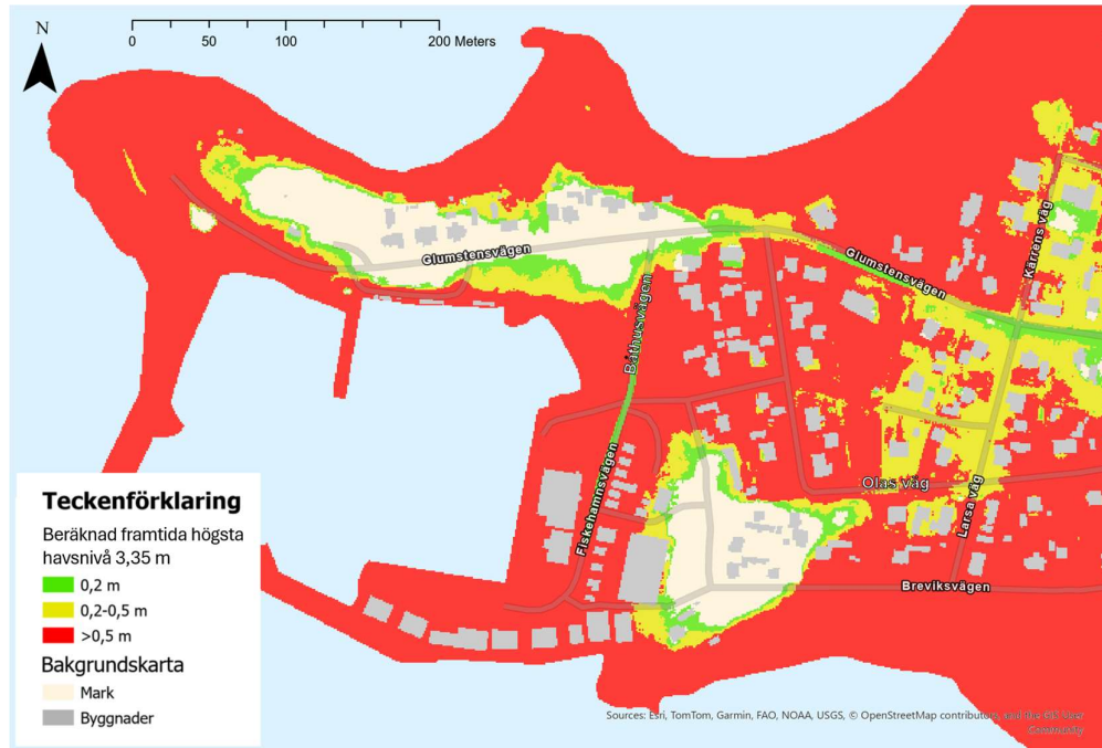
Figur 2-17. Utbredningen av vatten samt vattendjup om Båthusvägen, Fiskehamnsvägen och delar av Glumstenvägen höjs till nivå 3,15 m. Grönt = vattendjup på 10–20 cm, gult = vattendjup på 20–50 cm, rött = vattendjup mer än 50 cm.
