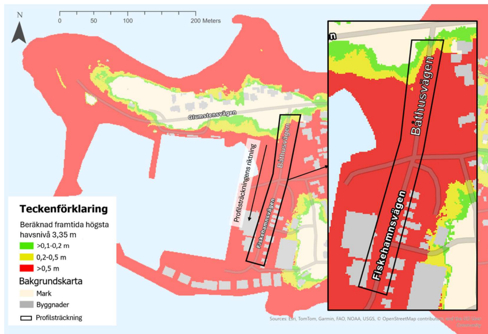
Figur 2-7. Profilsträckning för Båthusvägen och Fiskehamnsvägen vid beräknad framtida högsta havsnivå på 3,35 m för att se vattendjupet där det är som värst. Grönt = vattendjup på 10–20 cm, gult = vattendjup på 20–50 cm, rött = vattendjup mer än 50 cm. Svart ruta visar profilsträckningen.
