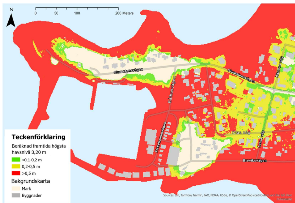
Figur 2-10. Profilsträckning för del av Glumstensvägen vid beräknad framtida högsta havsnivå på 3,20 m för att se vattendjupet där det är som värst. Grönt = vattendjup på 10–20 cm, gult = vattendjup på 20–50 cm, rött = vattendjup mer än 50 cm. Svart ruta visar profilsträckningen.
