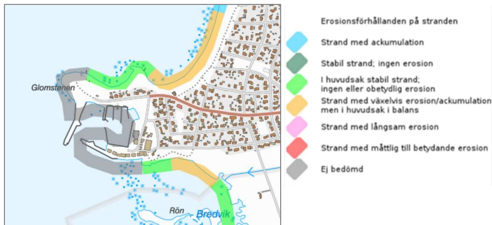
Figur 35. Erosionsförhållanden på städerna norr och söder om Glommen (SGI, 2025). Längs befintlig hamn (hård kajkant) och erosionssäker pir anges "ej bedömd". Dessa områden bedöms inte utgöra någon erosionsrisk eftersom det är hårda kajkonstruktioner.
