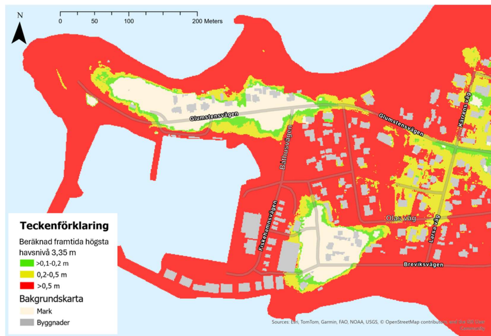
Figur 33. Vattendjup år 2130 vid återkomsttiden 1/10 000 vilket motsvarar en havsnivå på 3,35 meter (RH 2000) (AFRY, 2026).
