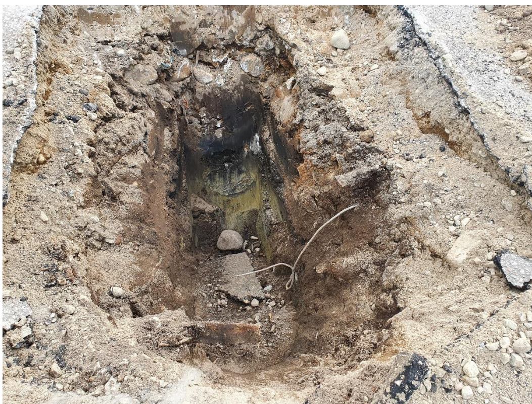
Figur 4: Provpunkt 20AF08. Avfall i fyllnadsmassorna i form av ledningar, plast, trä m.m. Bildkälla: AFRY 2020-07-21.
