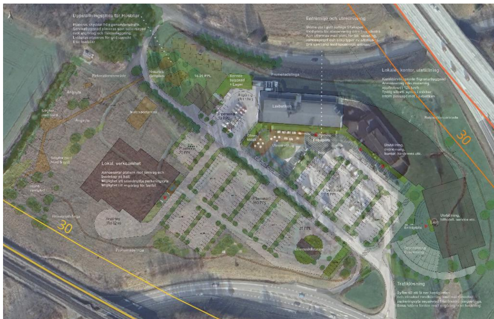
Figur 22. Visualisering av det gällande reducerade avstånd (30 meter) från närmaste väggkant respektive räl för samtliga typer av bebyggelse.
