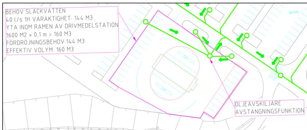
Figur 23. Yta avsedd för ytlig hantering av släckvatten illustrerat som lila linje. Vid ett släckvattenscenario stängs brunn med oljeavskiljare av så inget släckvatten leds vidare. Släckvatten tillåts fördröjas ytligt och kan sedan omhändertas via mobila tankar, cisterner eller slamsugning eller likvärdigt. Avstängningsventil på utlopp från drivmedelstation. Oljeavskiljare skall vara av klass 1, vilket är krav för bensinstationer enligt standarden SS-EN 858 1/2.
