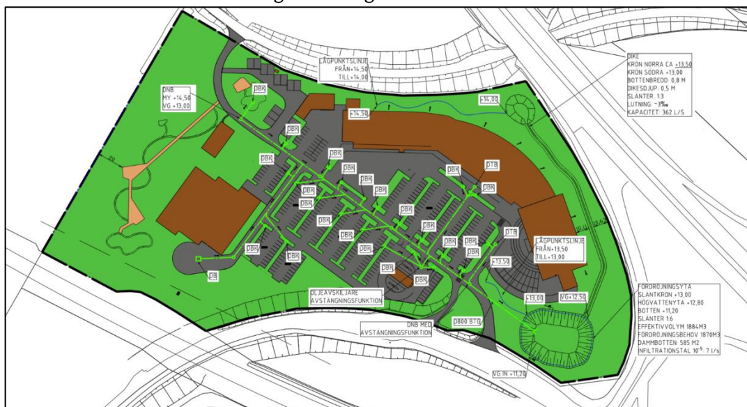
Figur 19. Dagvattenprincip i förhållande till den planerade bebyggelsen. Dagvatten fångas upp via rännstensbrunnar, kupolsilsbrunnar och regnbäddar för att sedan ledas österut mot föreslagen fördröjningsyta. Bruna ytor illustrerar takytor, gråa asfalterade/hårdgjorda ytor, gröna ytor (vegetationsytor). Utredningsområdet illustreras som svart tjock linje.
