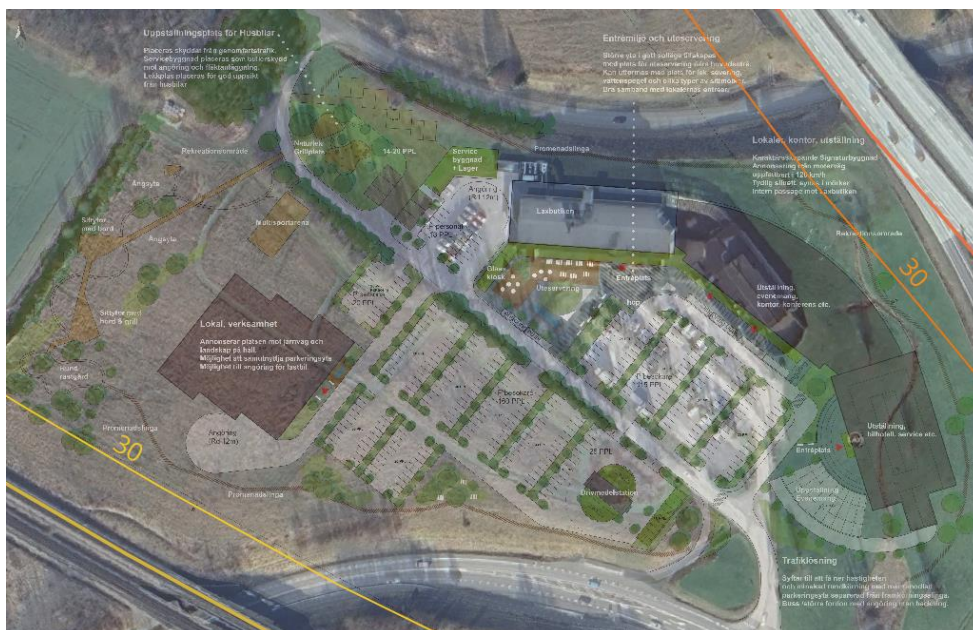
Figur 18. Visualisering av det gällande reducerade avstånd (30 meter) från närmaste väggkant respektive räl för samtliga typer av bebyggelse.
