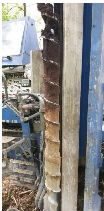
Figur 6. Nedre delen av skruven visar bedömt naturligt förekommande material i form av sand och silt i provpunkt 20AF12. Foto: AFRY 2020-06-03.
