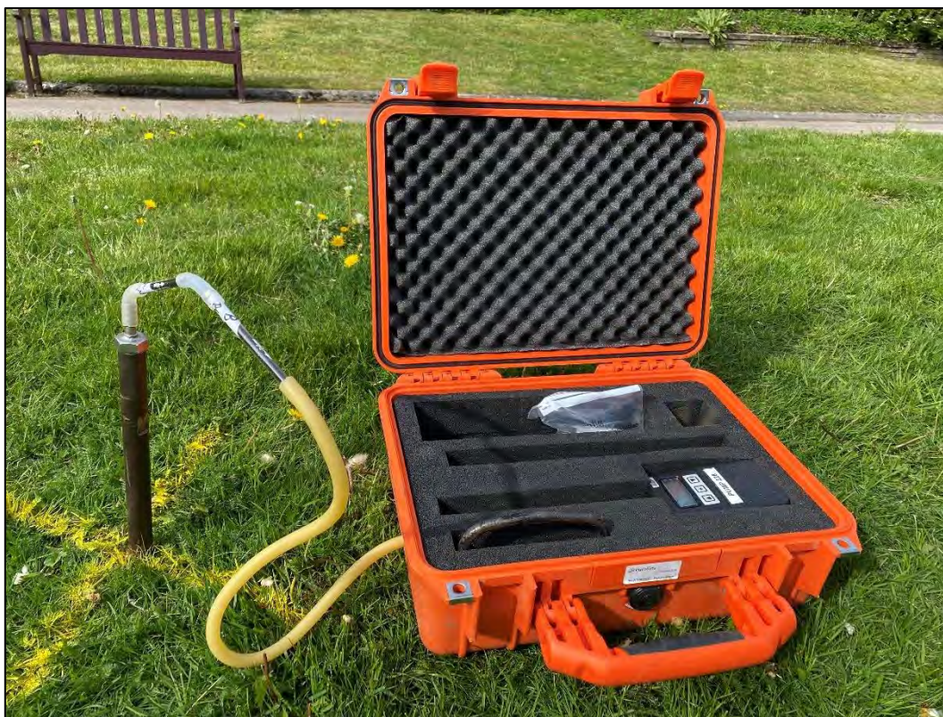
Figur 11. Porgasmätningen utfördes genom aktiv provtagning med kalibrerad lågflödespump. Porgasspetten slogs ner i marken till önskat provtagningsdjup med hjälp av slägga.
