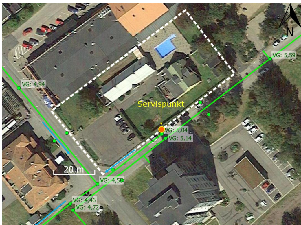
Figur 6 Dagvattenledningsnät (kommunalt) och servispunkt för planområdet. Höjder presenteras i meter i RH2000.
