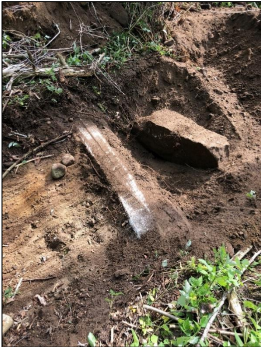
Figur 17. Rester av betongfundament eller vägg i provpunkt 21AF04. Foto: AFRY.
