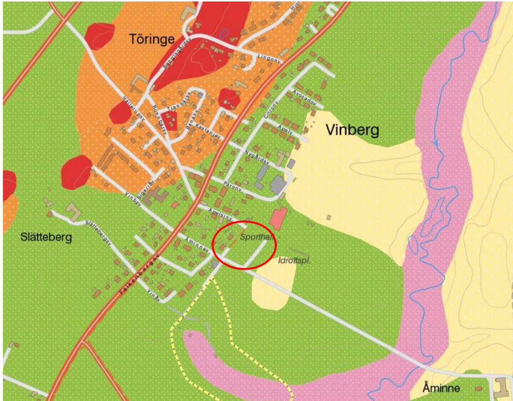
Figur 4. Utdrag ur SGU:s kartdatabas. Grön färg markerar utbredning av isälvsediment och ljusgul färg är lera. Undersökningsområdets ungefärliga läge är markerat med en röd cirkel. Källa: www.sgu.se .
