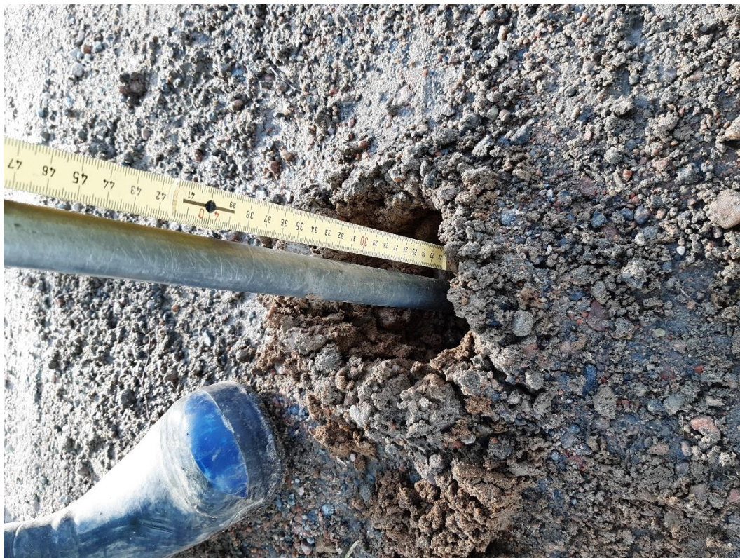
Figur 6. Proverna 21AF07 och 21AF08 togs från borrhål gjorda med handskrubborr i en grusväg. Bildkälla: AFRY 2021-02-25.
